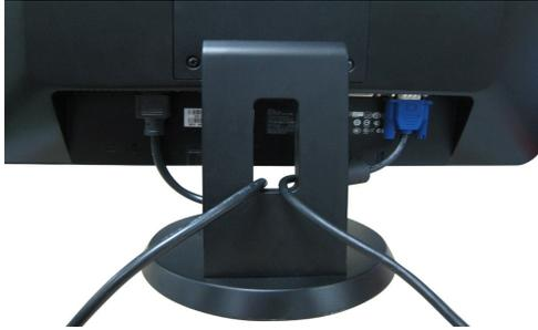
將所有必要的連接線連接至您的顯示器與電腦之後（請參見[連接您的顯示器](#)連接連接線），請如上圖所示使用連接線整理槽整理所有的連接線。
